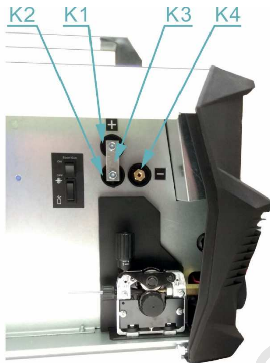
Obrázek 13. Detail terminálů změny polarity MIG/MAG hořáku
