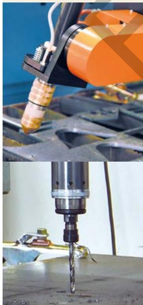
◀ Der 3D automatische Plasmakopf erweitert die Anwendungsmöglichkeiten der CNC-Maschine Vanad BLUESTER
