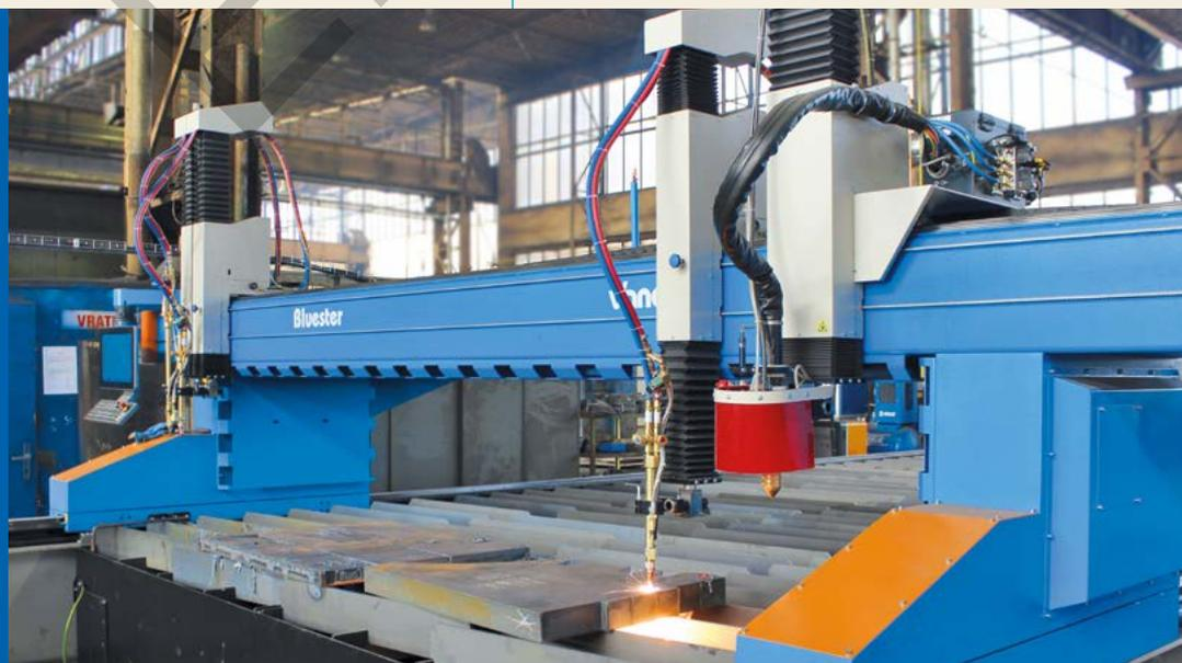
◀ Der Brennschneid-arbeitsplatz Vanad BLUESTER 45 x 120 mit Plasmaanlage Kjellberg HiFocus 440i und mit Autogentechnologie (gebaut in 2014)
