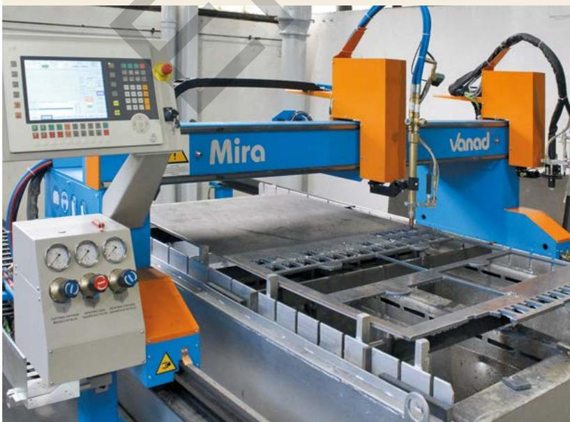
◀ Der Schneidarbeitsplatz MIRA wurde im Jahr 2013 mit der Plasmaanlage Hypertherm Powermax 105 gebaut
