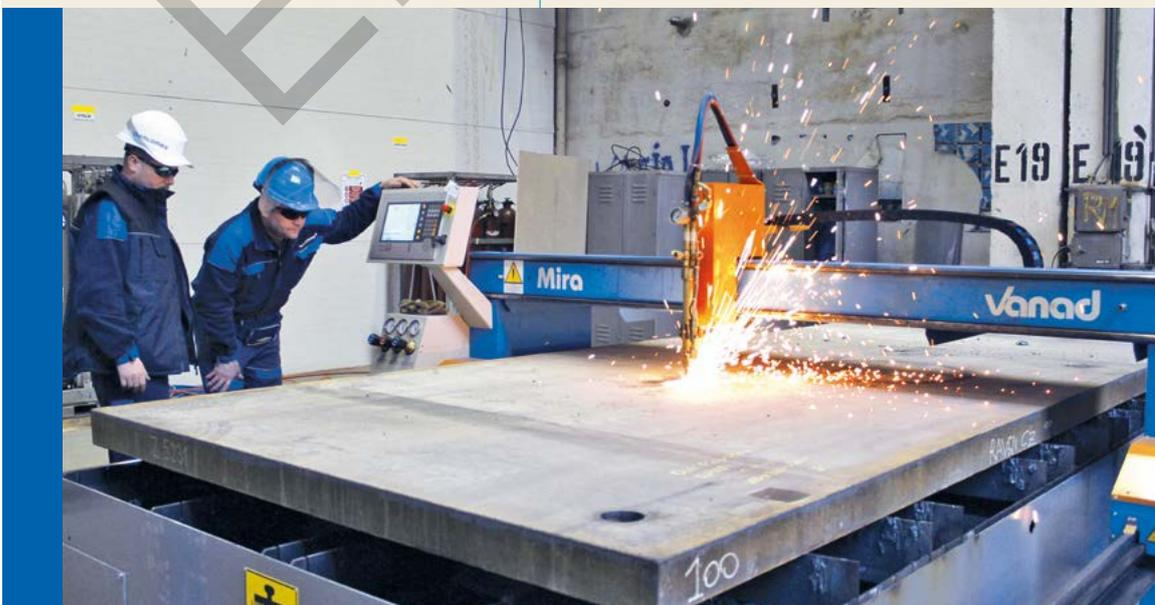
◀ Die CNC-Schneidmaschine Vanad MIRA ist mit Autogentechnologie, Laserpointer und elektrischer Flamenzündung des Autogenbrenners ausgerüstet. Das Bild zeigt das Lochstechen von 100 mm Baustahl. Die CNC-Maschine MIRA wurde auch in unserem Vorführcentrum installiert, wo Sie sie ansehen und ausprobieren können
